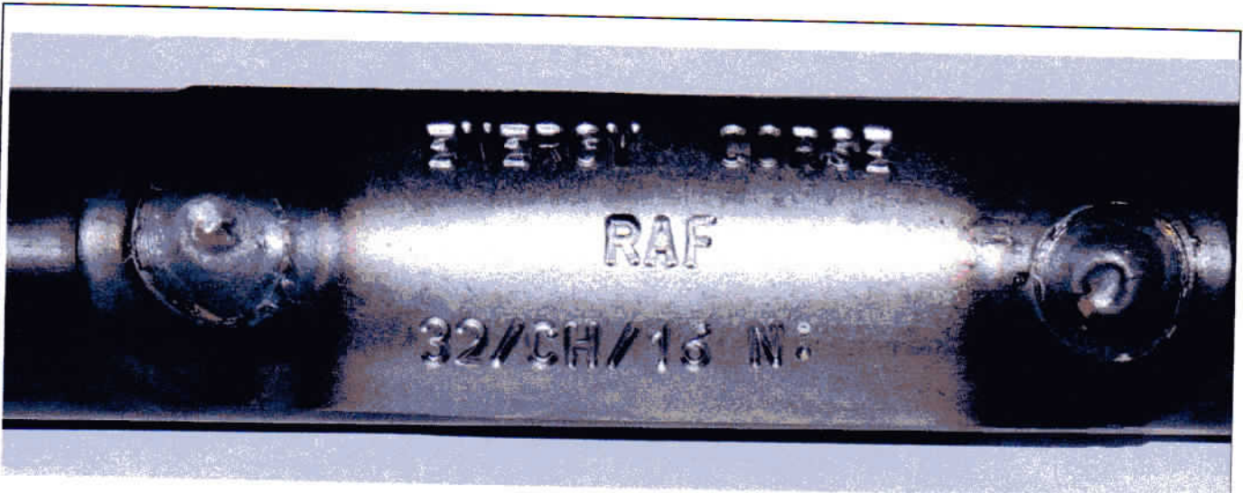
Фотография регистрационной таблички (Photograph of Homologation Number marking)
